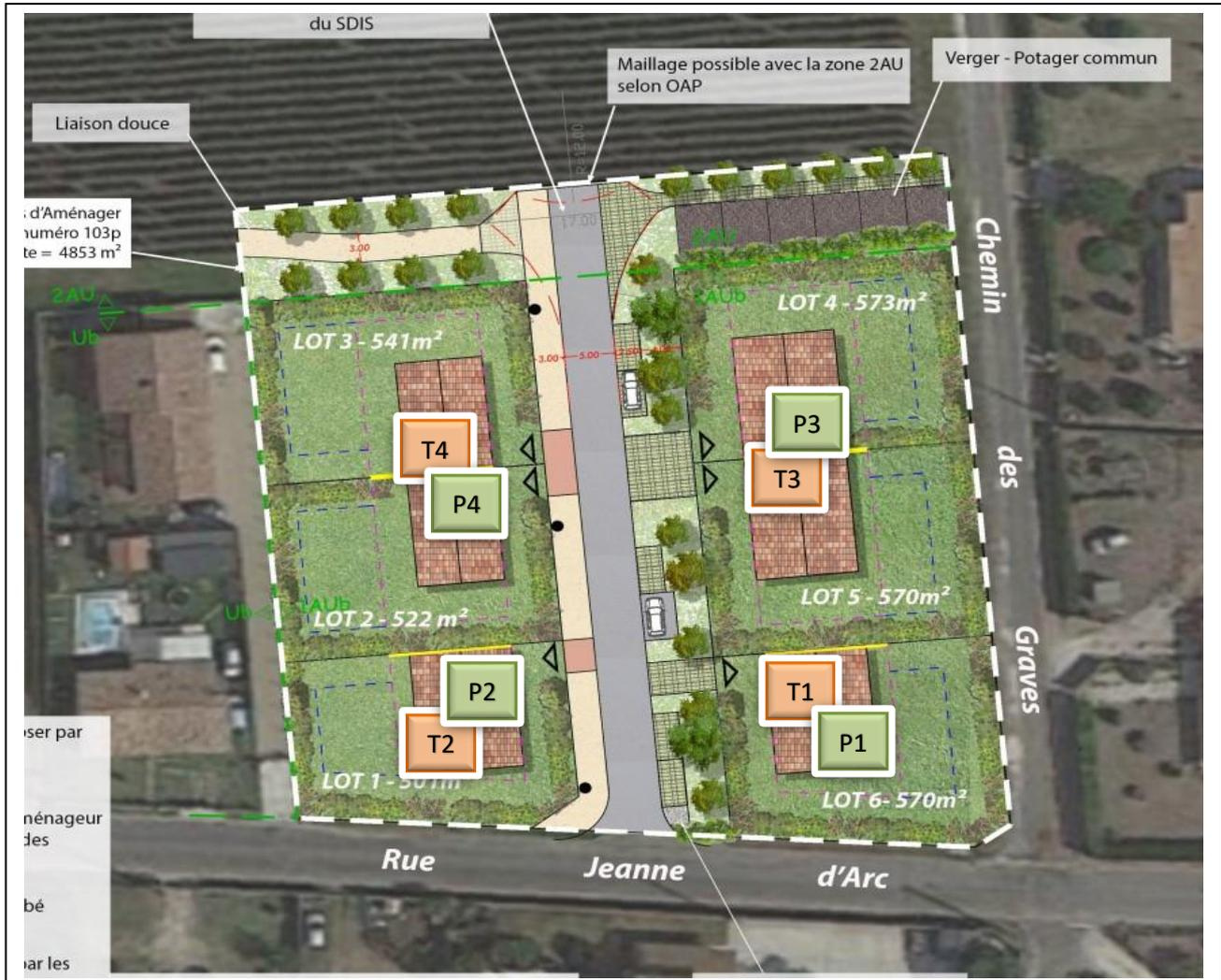
Sondage pénétromètre dynamique : P1 P2 P3 P4
